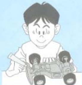
8 齿轮、轴承、弹性部件等要再加抹润滑油
