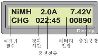
설정된 전류값으로 충전하는 프로그램입니다. 자동 전류 모드('A')에서는 충전기의 과다한 전류 공급으로 인한 배터리 손상을 방지하기 위하여 자동으로 설정되는 전류의 상한 값을 설정합니다. 낮은 내부 저항값을 가진 작은 용량의 배터리들의 경우 과다한 충전 전류 값이 자동으로 설정될 수 있기 때문입니다. 그러나 수동 전류 모드('M')에서는 설정된 전류값으로 충전합니다.
