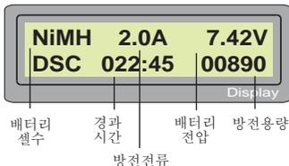
방전 전류와 방전 후 최종 전압 값을 설정합니다. 배터리 손상을 방지 하기 위하여 최종 전압 값은 0.85V/셀(NiCd), 1.0V/셀(NiMH) 이하가 되지 않도록 하십시오. 'AUTO' 로 설정하면, 기본 방전 전압으로 방전됩니다.
