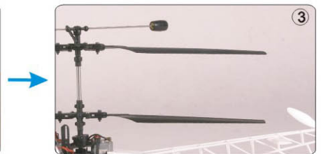
(3) 主旋翼旋转在同一平面 Main blades rotate in one plane.
