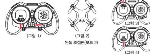
2. 쿼드콥터의 전원을 켜고 쿼드콥터를 정지된 상태로 지상에 놓습니다. 쿼드콥터에 전원이 들어옵니다. (그림 2와 같이 표시)
